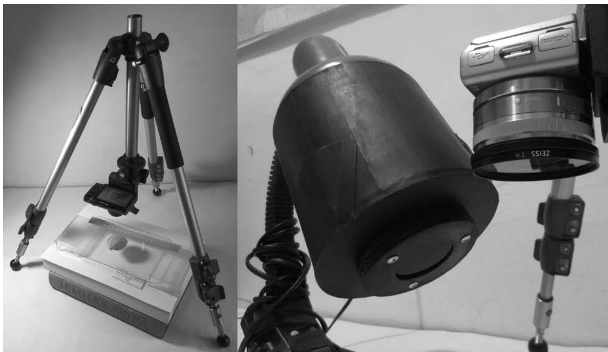
Рис. 1. Засоби для зйомки черепашок при звичайному освітленні (ліворуч) та для зйомки їхньої люмінесценції, збудженої ультрафіолетом (праворуч).
